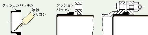
**フランジ接合** (ノンタールエポキシ塗装鋼管、配管用炭素鋼管専用)
