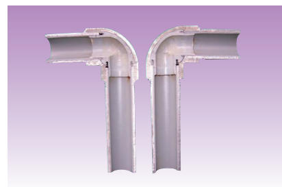
●19年使用した給水管の半割り内面 (内面もらい錆除去後)
