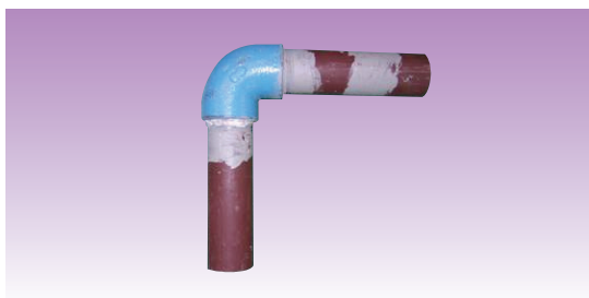
●19年使用した給水管の外観
