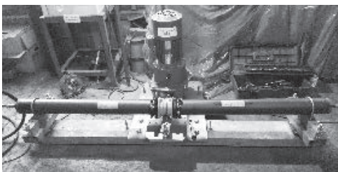
適用化検証試験で実施した繰り返し曲げ試験
