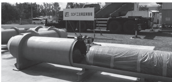
写真1 600A曲げ通過試験の状況
