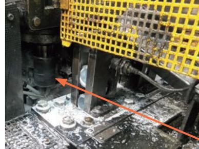
水溶性の切削油を注入しながら自動ねじ加工
