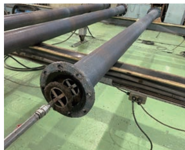
ピンホール検査
