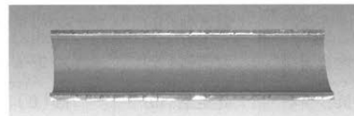
●30年使用した給水管の半割り内面 (内面もらい錆除去後)
